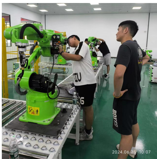
图1 实践小组进行机械臂组装
